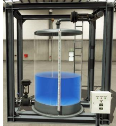
Figura 1. Tanque de Nivel.
