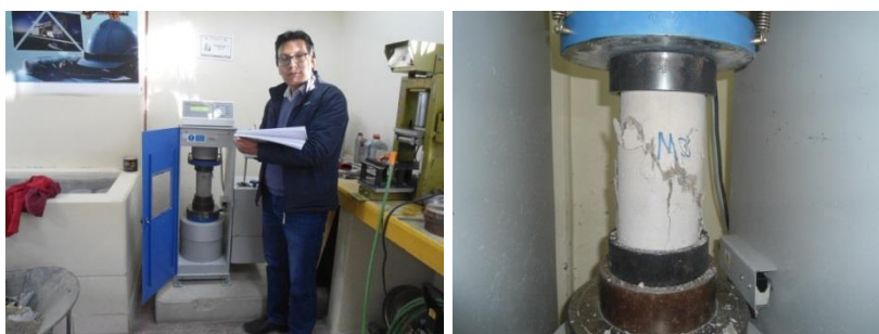
a. Equipo de compresión simple b. Especímen sometido a ensayo a compresión
